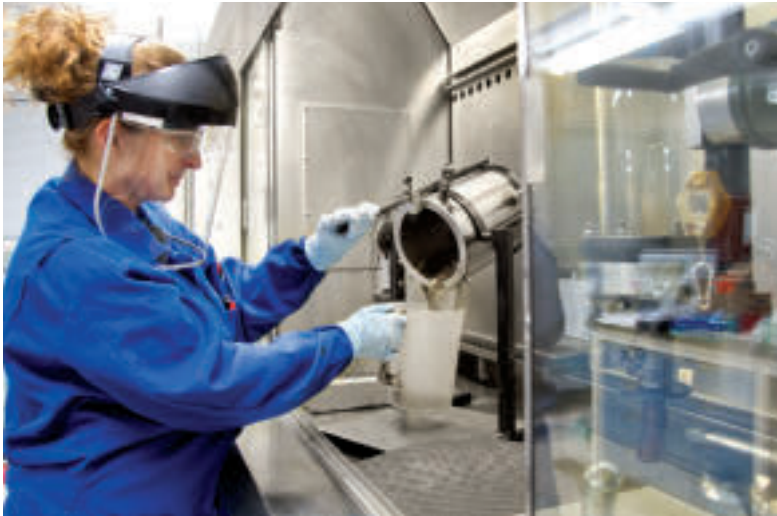
Giovanna Stea met à l'essai une méthode de production de résidus secs dans le laboratoire d'extraction sans eau.
